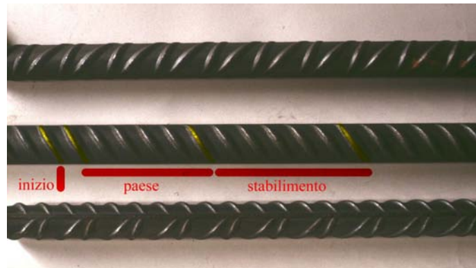
Figura 1-8 Geometria dei risalti e marchio di identificazione
